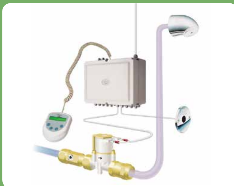
Voorbeeld van een elektronisch zelfsluitend systeem met een centrale besturingskast
