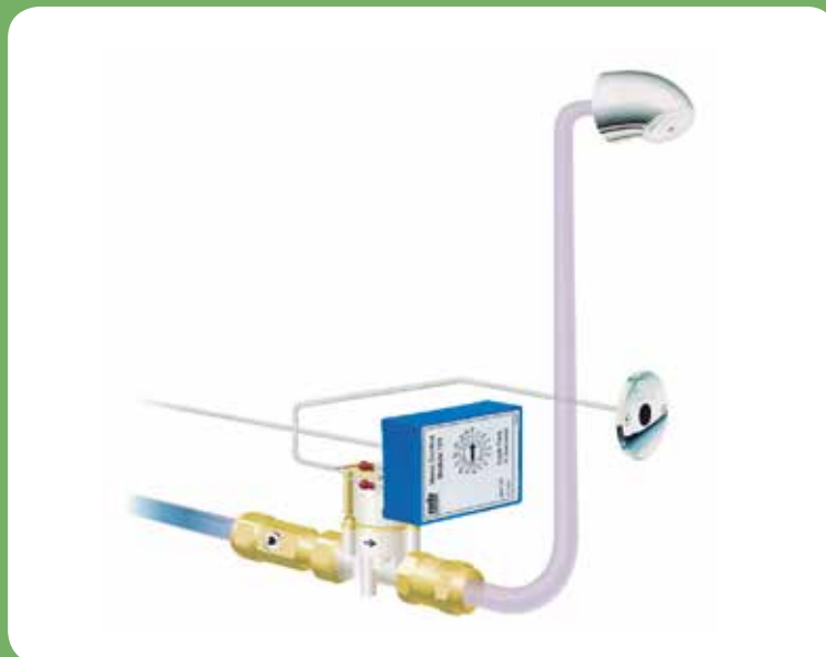
Voorbeeld van een elektronisch zelfsluitend systeem met besturingsunit voor één tappunt
