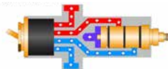
Thermostatische mengkraan zonder keerkleppen Service van de therm. patroon mogelijk, in gesloten stand. Zonder het water af te sluiten!
